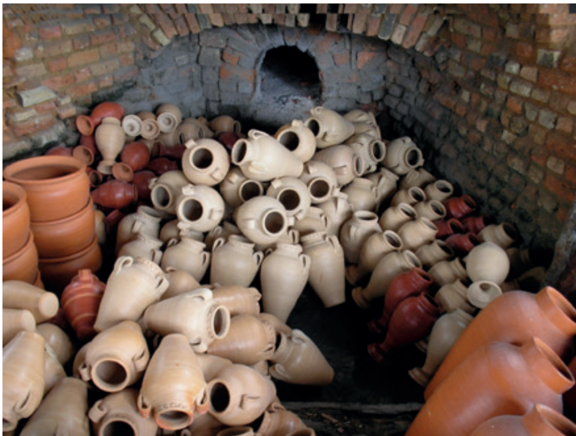
Figura 4. Maragogipinho. Interior de um grande forno de câmara com recipientes já queimados.
