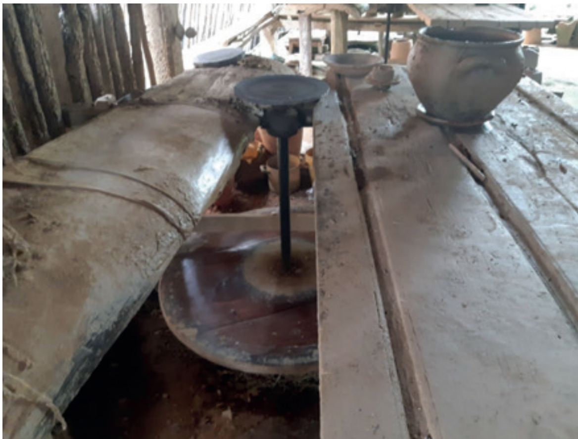
Figura 3. Maragogipinho. Mesa, banco e torno de pedal, no interior de uma olaria contemporânea.
